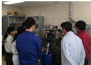
直接打錠法による口腔内崩壊錠の製造(榎野先生)
