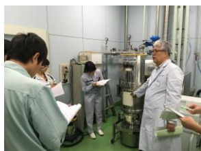
顆粒圧縮法による口腔内崩壊錠の製造(中道先生)
