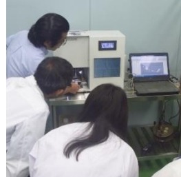
GRANO (岡田精工) を 用いて顆粒硬度も測定
