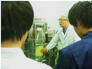
流動層造粒による 顆粒の調製
