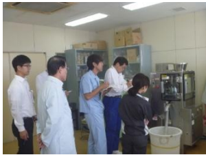
粉体の混合とローラー打錠機による製錠
